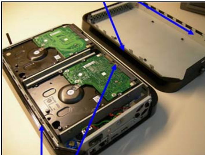
Ilustración 135: Alineación de pestañas y ranuras
